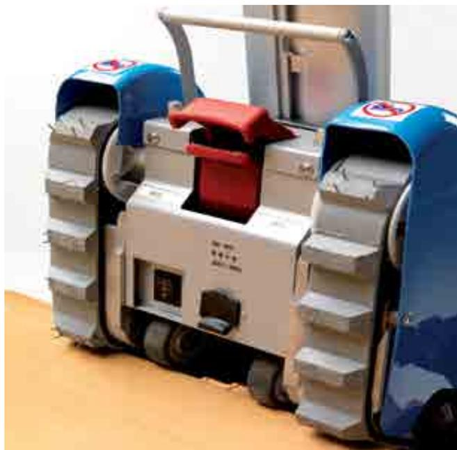
Duplo bloqueio, elétrico e mecânico, do encaixe de emergência da barra de apoio ao corpo do motor
